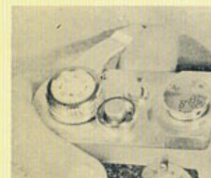
⑪ 捲上げレバー……捲上げレバーを1操作するだけで、シャッターのセットと、フィルムの捲上げが同時に行えますから連続速写にすぐれた性能を発揮します。
