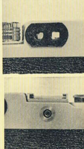
④ F・X接点自動切換式シンクロ装置……シャッターを  $\frac{1}{25}$  秒以下にすると自動的にX接点に切換えられる1接点シンクロ装置は、操作が簡便で全速度に対して完全に同調します。
